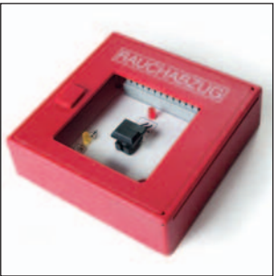
КНОПКА АВАРИЙНОЙ СИТУАЦИИ HE 075 КОД 40564B Задействуется при разбитии стекла, содержится в красной коробке. Сигнализация контроля через зеленую лампочку, сигнализация аварийной ситуации с помощью красной лампочки, сигнализация нарушения питания в сети с помощью желтой лампочки. Есть функция перезагрузки.
