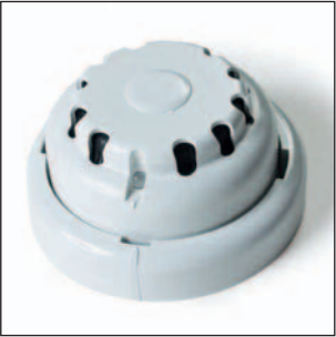
ОПТИЧЕСКИЙ ДАТЧИК ДЫМА КОД 36418Q С эффектом Tyndall. Сертифицирован в соответствии с нормами UNI EN 54 7/9. Сигнализация аварийной ситуации с помощью красной лампочки. ВРЕМЯ ОТВЕТА примерно 3 секунды НАПРЯЖЕНИЕ ПИТАНИЯ 24 V (мин. 10 V, макс. 30 V) РАБОЧАЯ ТЕМПЕРАТУРА -10° + 80°C ВЛАЖНОСТЬ < 95% МАКСИМАЛЬНАЯ СКОРОСТЬ ВОЗДУХА 10 м/сек ЗАЩИЩЕННАЯ ПЛОЩАДЬ 40 м2 Рекомендуется регулярно чистить пыльные помещения.
