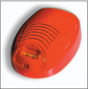
УСТРОЙСТВО АКУСТИЧЕСКОЙ СИГНАЛИЗАЦИИ КОД 40892C Наружная сирена, стальной контейнер с крышкой из поликарбоната, звуковая мощность 115 dB, питание 24 V - 2 A, аккумулятор 12 V, 2 Ah. Размеры: мм. 236x280x99
